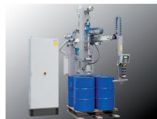
Halbautomatische Paletten-Abfüllung mit Schraubwerkzeug Typ USP1000-91PS Ex.
