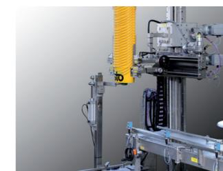
Gebindemagazin zur Entstapelung von Farbeimer.
