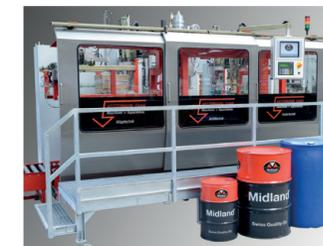
Vollautomatische Fass-Abfüllung Typ USP200-91V.
