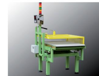
Metergewichtswaage Typ MG800 für dynamische Verwiegung von ungeschnittenen Materialstränge.
